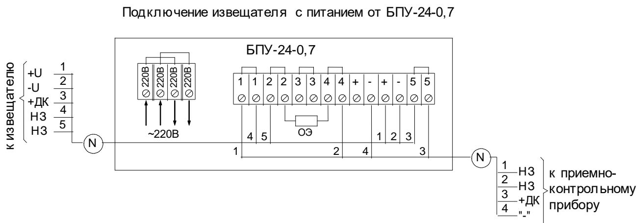
Рисунок 2.10 – Схема подключения двух извещателей к блоку питания «БПУ-24-0,7»
